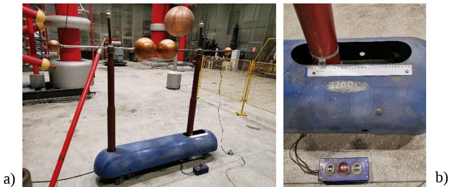
Fig. 8 – Dispunerea elementelor de comandă, măsură și semnalizare pe pupitrul de comandă.
